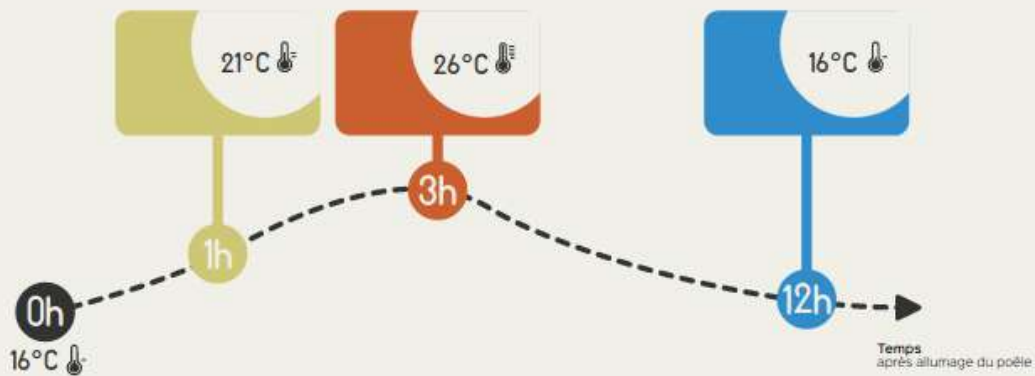
Courbe température d'un poêle classique - Fonds Agir Low-tech Licence CC BY SA 4.0.
